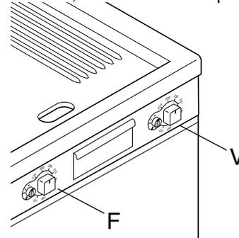
La válvula termostática "F" situada a la izquierda manda el funcionamiento del horno de gas.
