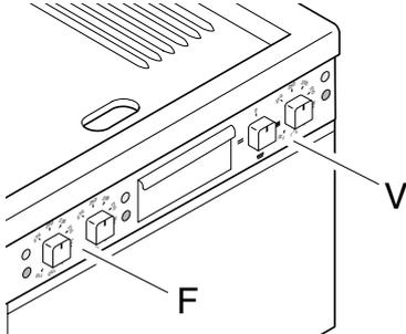
Los mandos del horno eléctrico "V" están ubicados a la derecha: Las resistencias están controladas por un selector de cuatro posiciones "D" mientras que la temperatura en el interior de la cámara está controlada por un termostato "E".
